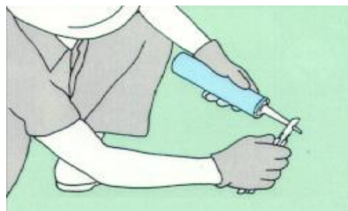
2. Příčně odříznout konec vyústku v požadované vzdálenosti.
